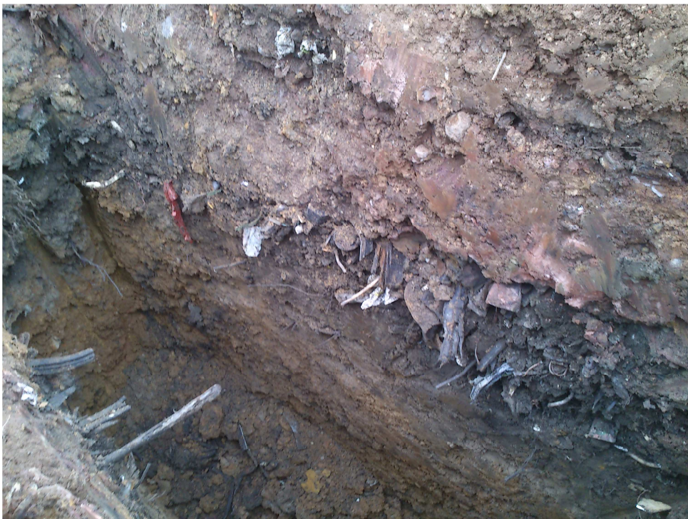
Zdjęcie 2. Wyrobisko I – widoczny profil pionowy: nasyp gliniasty z okruchami betonu i kamieni, warstwa odpadów, grunt rodzimy
